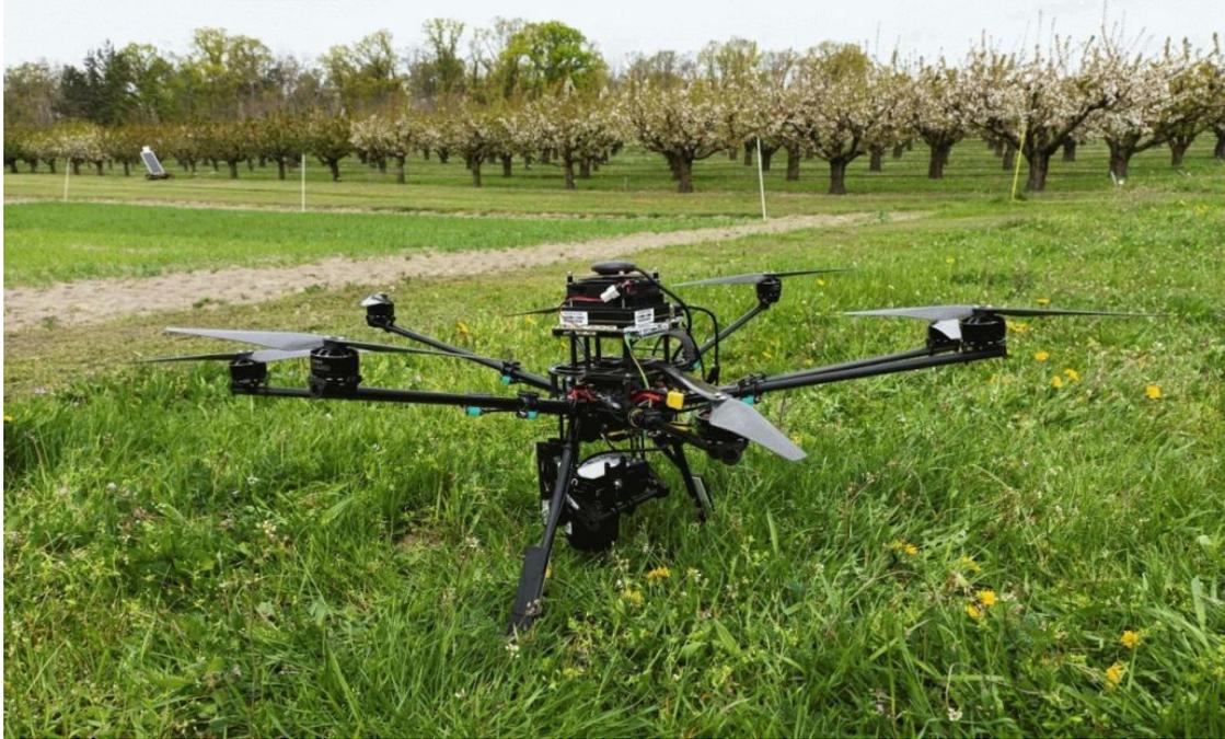
Abbildung 21: Die in weed-AI-seek eingesetzte Flugdrohne OKTOPUS XL des Projektpartners CiS GmbH mit weed-AI-seek-Hardware im Feldversuch.
