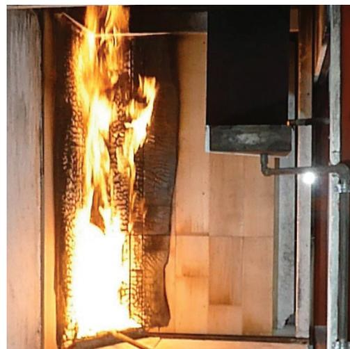
(b) Probekörper im SBI-Prüfstand während des Versuches
