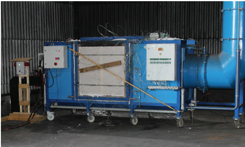
Abbildung 1 Bauteilofen H2 mit eingebauten Wandprobekörpern
