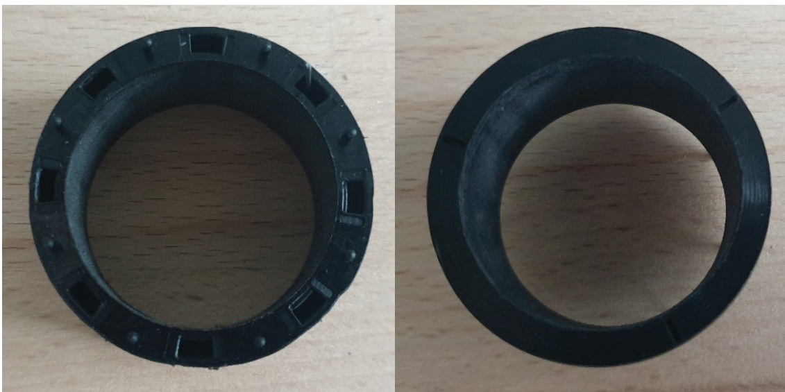
Abbildung 1: Kunststoffgleitlager aus leitfähigem und nichtleitfähigem thermoplastischem Kunststoff
