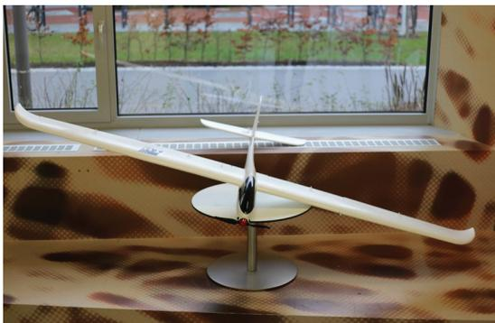
Abbildung 2: Proof of Concept für die Miniaturisierung des ATISS (2,40 m Spannweite)
