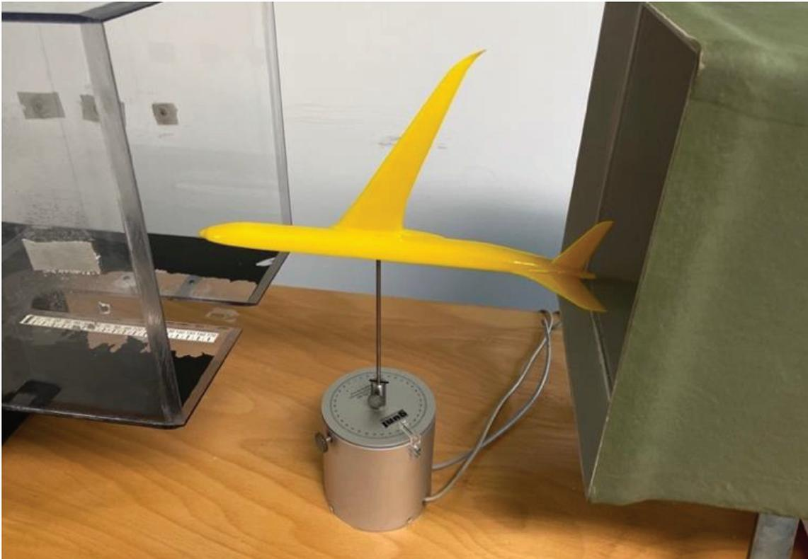
Abbildung 4: Im Kraftsensor befestigter Prüfkörper
