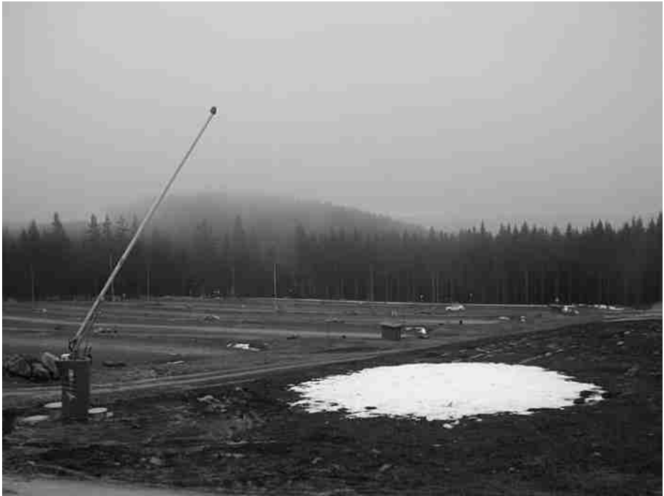
Abbildung 1: Eine Schneelanze in Braunlage nach einem gescheitertem Beschneivungsversuch.
